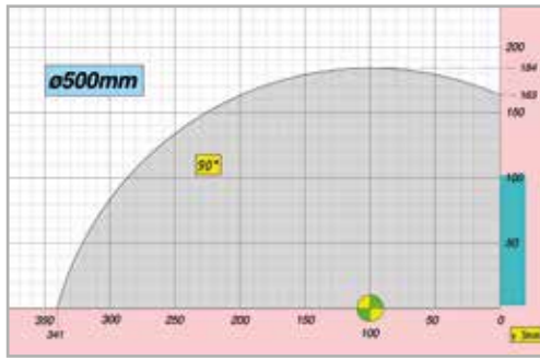
Diagrama de corte. /Cutting diagram Soporte del perfil en la posición atrás / Suporte do perfil na posição para trás
